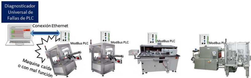
Figura 1. Configuración de programa instalado para diagnóstico directo sobre la Máquina Objetivo en mal funcionamiento.
